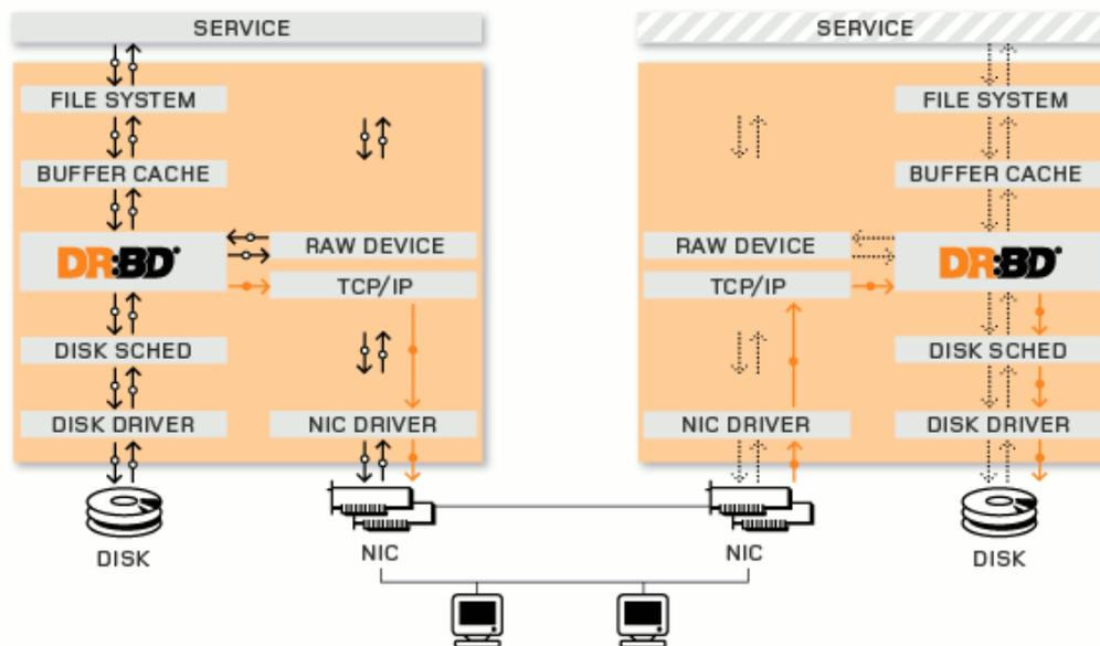
从图中我们可以看出，DRBD 介于文件系统与磁盘介质之间，通过捕获上层文件系统的所有 IO 操作，然后调用内核中的 IO 模块来读写底层的磁盘介质。当 DRBD 捕获到文件系统的写操作之后，会在进行本地的磁盘写操作的同时，以 TCP/IP 协议将，通过本地主机的网络设备(NIC)将 IO 传递至远程主机的网络设备。当远程主机的 DRBD 监听到传递过来的 IO 信息之后，会立即将该数据写入到该 DRBD 所维护的磁盘设备。至此，整个 IO 才做完成。
